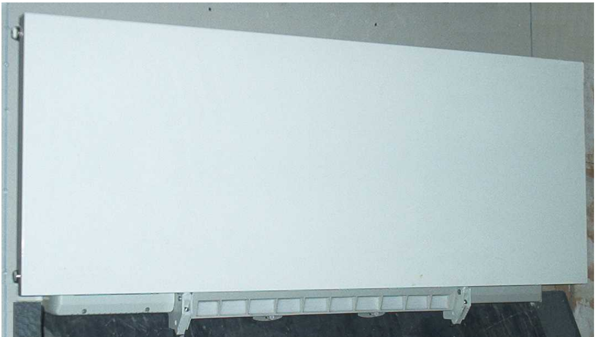
Figuur 3: Radiator met daarachter ventilatie-unit in meetopening ('binnenzijde') (absorptiemateriaal wordt tussen de ventilatie-unit en radiator geplaatst)
